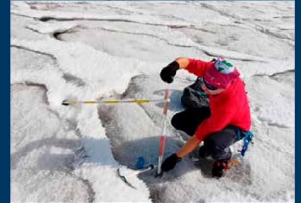
Figura 2. Operazioni di rilievo delle paline ablatometriche sul ghiacciaio dell'Adamello a chiusura tardiva della stagione il 13 ottobre 2023 (foto A. Scaltriti).
